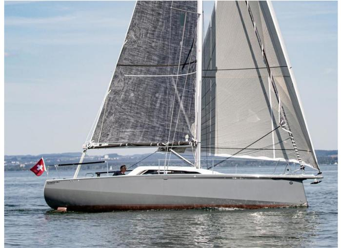
Die Sunbeam 29.1 ist eine moderne Segelyacht, die für Wochenendtörns und Tagesausflüge konzipiert wurde. Sie ist mit einem hydraulischen Schwenkkiel ausgestattet, der einen Tiefgang von 0,85 bis 1,85 Metern ermöglicht. Auf diese Weise kann die Yacht auch in seichten Gewässern gesegelt werden.
